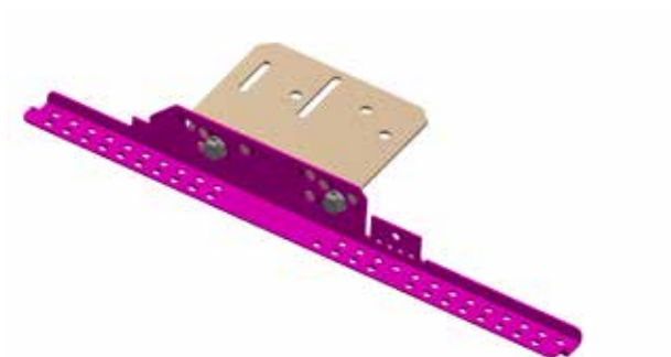
Infästning på råspont (vid 25x48 mm läkt)
