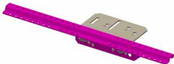
Bild 2. Infästning på läkt 45x70 mm
