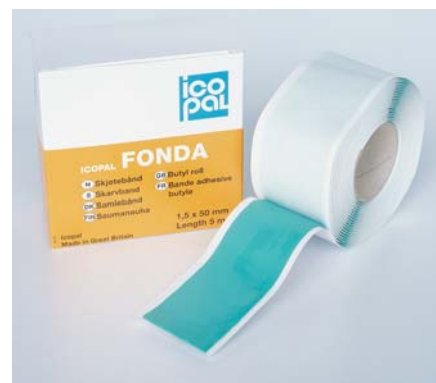
Icopal Fonda Skarvband av butyl, för att ansluta mot vägg och tätas vid genomföringar och tvärskarvar. 1,5 mm x 50 mm x 5 m. 1,5 mm x 50 mm x 10 m.
