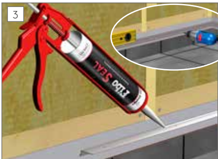
3 I våtrum används en sockellist som monteras minst 60mm från golv. Alla lister rengörs innan användning med Fibo Clean och Fibo Wipes. Läggs fogmassa på baksidan av listen nedanför skruvhålen och montera listen vågrätt. Se också punkt 18. Detta gäller både för standard invändig hörnlist och den 2-delade invändiga hörnlisten.
