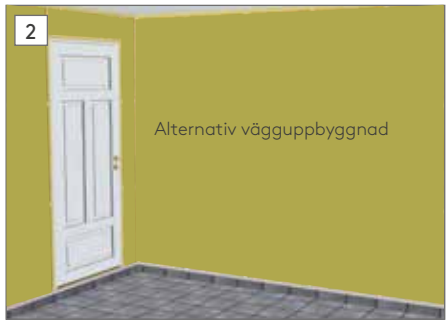
2 Alternativ vägguppbyggnad För bästa resultat använd minst 12mm byggplywood bakom skivorna. OBS! om klinker ska sättas mot väggen måste en godkänd skiva monteras minst 200mm upp från golv. Om golvet läggs med våtrumsmatta skall mattan upp minst 150mm på väggen. Se monteringsanvisning för klinker/plastmatta.
