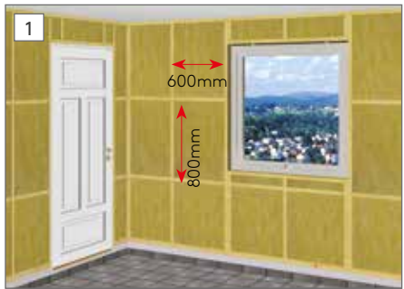
1 Skivorna ska förvaras liggande i originalförpackning minst 3 dygn innan montering för att aklimatiseras . Skivorna monteras på befintlig skruvfast vägg eller på regelverk c/c 600mm med kortlingar c/c 800 mm. Om tunga föremål ska hängas upp måste dessa ha kortlingar
