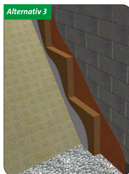
Figur 5.5: Källarvägg med Isodrän
